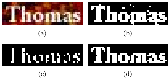
Figura 11: Imagem com caracteres de fontes reduzidas e baixa densidade. (a) Imagem original. (b) Método de Otsu. (c) Método de Jain & Yu (7 clusters). (d) Método proposto (2 clusters).
