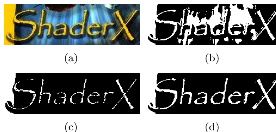
Figura 8: Imagem com plano de fundo complexo e caracteres de baixa densidade. (a) Imagem original. (b) Método de Otsu. (c) Método de Jain & Yu (10 clusters ). (d) Método proposto (5 clusters ).
