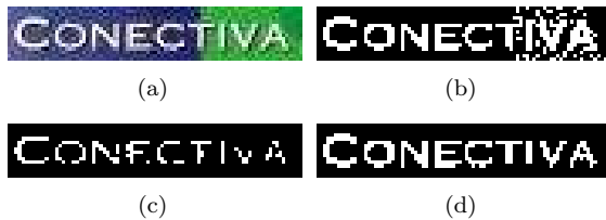
Figura 10: Imagem com artefatos e caracteres de baixa densidade. (a) Imagem original. (b) Método de Otsu. (c) Método de Jain & Yu (6 clusters). (d) Método proposto (2 clusters).
